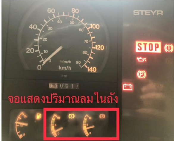
ภาพที่ ๑ เมื่อปิดสวิตช์ ON กรณี ไม่ใส่สายอัดลมอัตโนมัติ
