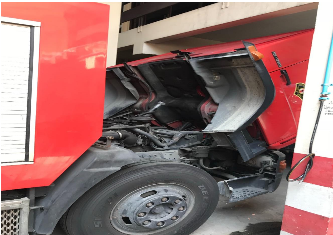
ไม่เป็นอุปสรรค ในการยกหัวแก๊สรถบรรทุกน้ำดับเพลิงในการตรวจสอบสภาพหรือ การตรวจสอบซ่อมบำรุงต่าง ๆ
