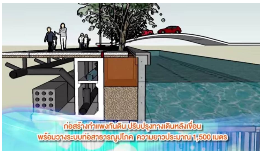
ภาพการปรับปรุงระบบระบายน้ำริมคลองโอง่าง
