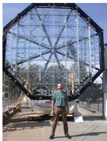
โจเบิร์ต แลง กับเลนส์ทดสอบเส้นผ่านศูนย์กลาง 5 เมตร
