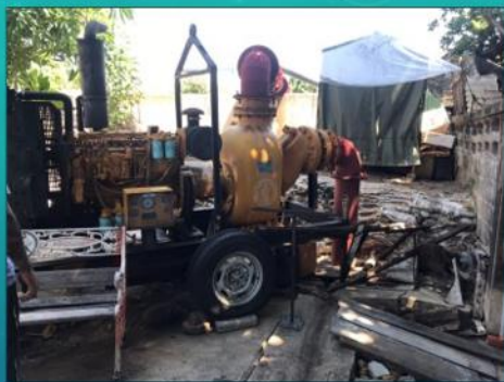
รูปถ่าย การติดตั้งเครื่องสูบน้ำชนิดเครื่องยนต์ดีเซลในชุมชน (จากรูปถ่าย คือชุมชนหมู่บ้านเปรมฤทัย ช.สุขุมวิท 50)
