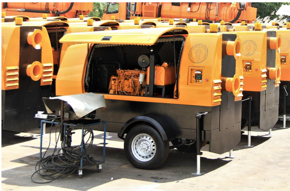
ภาพตัวอย่าง : เครื่องสูบน้ำระบบไฮดรอลิก (Hydraulic Pump) ขับด้วยเครื่องยนต์ดีเซล
