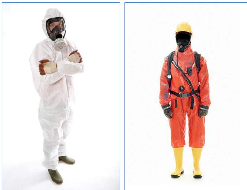
ภาพที่ ๗ ชุดป้องกันอันตรายส่วนบุคคลขณะปฏิบัติงานกับแอมโมเนีย
