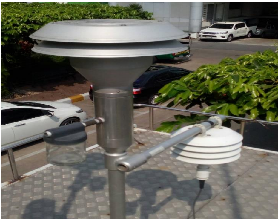
อุปกรณ์คัดกรองอากาศบนสถานีตรวจวัดคุณภาพอากาศและเสียง
