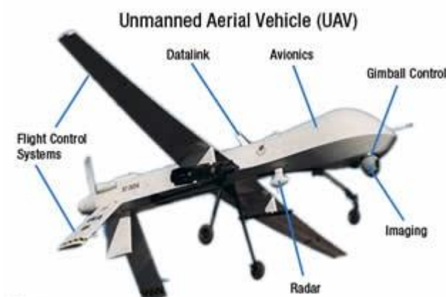
ภาพที่ ๒ ส่วนประกอบหลักของอากาศยานไร้คนขับ (UAV: Unmanned Aerial Vehicle)
