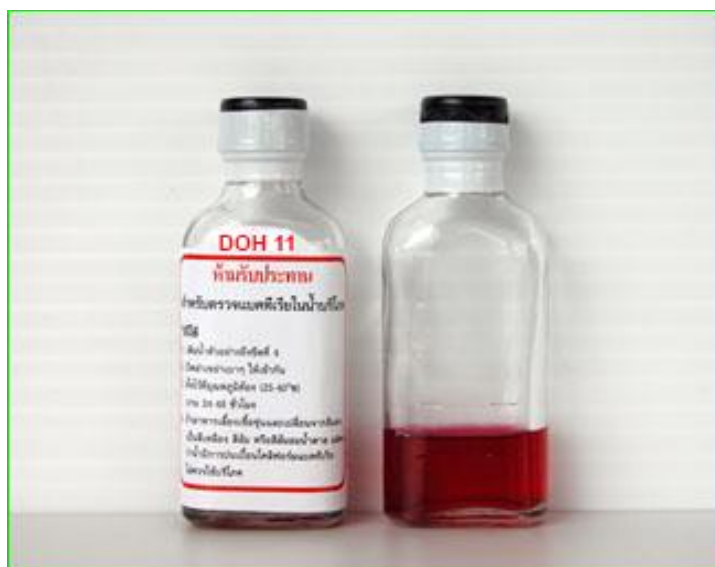
ภาพที่ ๒ ชุดทดสอบโคลิฟอร์มแบคทีเรียในน้ำ (อ ๑๑)
