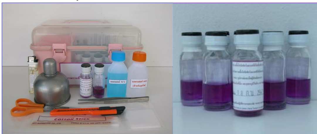
ภาพที่ ๔ ชุดอุปกรณ์การตรวจสอบโคลิฟอร์มแบคทีเรีย อ. ๑๓
