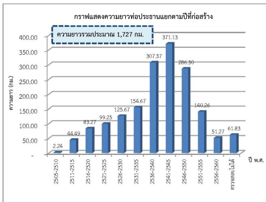
รูปที่ ๔ กราฟแสดงความยาวท่อประธานของการประปา นครหลวงแยกตามปีที่ก่อสร้าง
