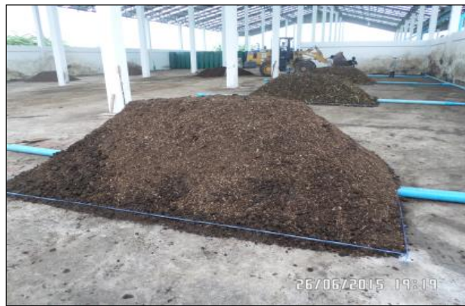
รูปที่ ๒ การทดลองแบบเติมอากาศ (Forced aeration)
